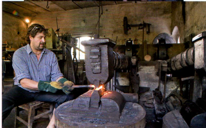
Zweieinhalb Tonnen wiegt der Hammer, der im Wasser getriebenen Takt auf das heiße Eisen niedergeht (oben). Den Feinschliff besorgt der Schmied an einem Schleifbock (links), den ebenfalls die Kraft des Wassers antreibt.
