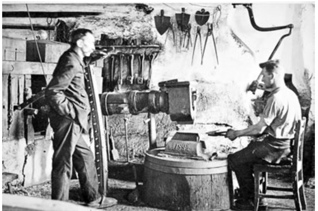
Wasserkraft treibt den Schwanzhammer an. 1894 steht auf dem Amboss. Das Foto entstand um 1950.
