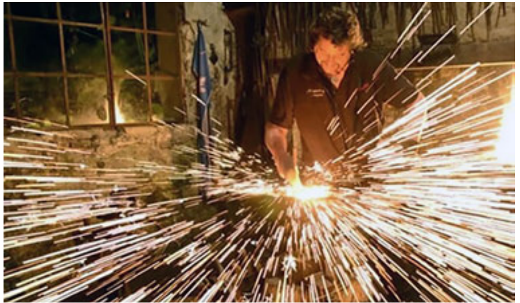
Die Funken sprühen, wenn Frank Wagenhofer arbeitet. Er liest die Temperatur des Metalls an den Farben ab: von Dunkelbraun bis Hellgelb, von 550 bis 1300 Grad Celsius. Fotos: Michaela Resch/privat
